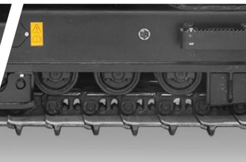
Protezione parasassi rulli e ruota motrice sottocarro
