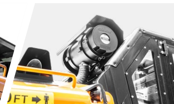
Sistema di pressurizzazione cabina
