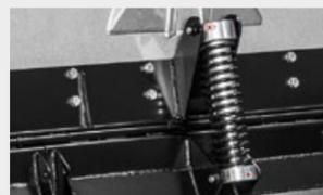
**Bandelle dosatrici ammortizzate** per livellare e compattare il materiale frantumato, creando una base uniforme
