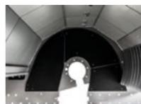
**Protezioni laterali** della fiancata interna del telaio facilmente sostituibili senza togliere il rotore: assicurano un'elevata resistenza all'usura, riducono i tempi di sostituzione
