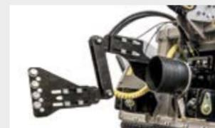
**Sistema di regolazione del parallelismo tipo W tra scatola, ingranaggi e cardano** permette alla trincia di lavorare in più angolazioni senza danneggiare la presa di forza
