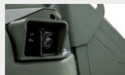
**Système de caméras à 360° et système I/R**
