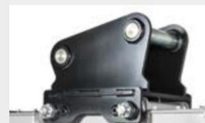
**Plaque d'attache avec axes**
