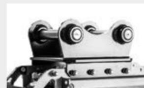
**Plaque d'attache avec axes**
