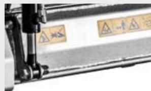
**Capot avant à réglage hydraulique**
