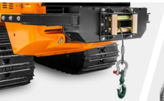
Treuil arrière, capacité 13 tonnes
