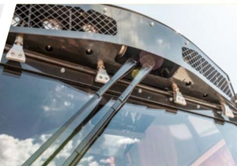
Système de nettoyage des vitres à air
