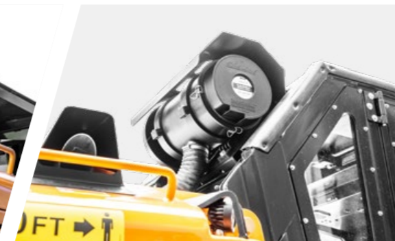
Système de pressurisation de la cabine
