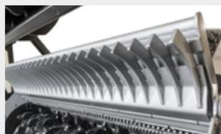
**Grille vissée sur le capot** permet le réglage de la granulométrie du matériau en sortie
