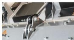
**Contre-couteaux interchangeables à peigne, forgés et trempés** pour une durée maximum dans le temps
