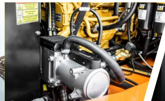
Système de préchauffage moteur et huile hydraulique
