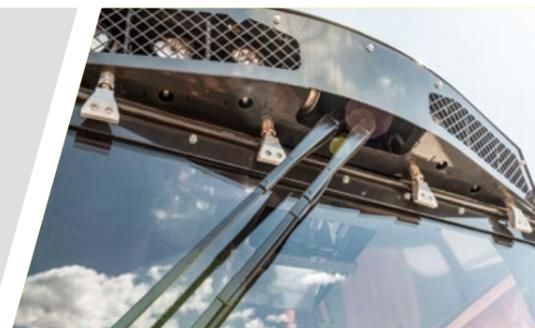
Système de nettoyage des vitres à air
