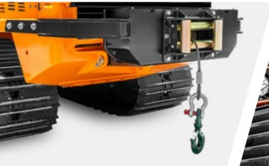
Treuil arrière, capacité 6 tonnes
