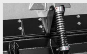
**Bandes de nivellement sur porte arrière amorties**
