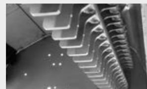
**Grille indépendante (capot arrière)** meilleur flux de la matière grâce à l'augmentation de la distance entre la grille et la porte arrière
