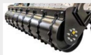
**Rouleau de support à réglage hydraulique** avec racleur de rouleau pour permettre le nettoyage de ce dernier
