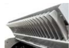
Grille vissée sur le capot permet le réglage de la granulométrie du matériau en sortie
