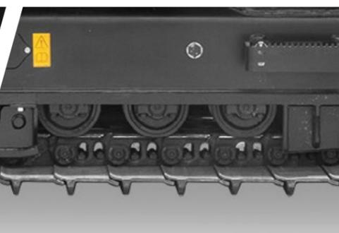
Protección antirrocas de los rodillos y de la rueda motriz del tren de rodaje
