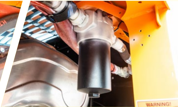
Sistema de filtración de trabajos pesados (drenaje)
