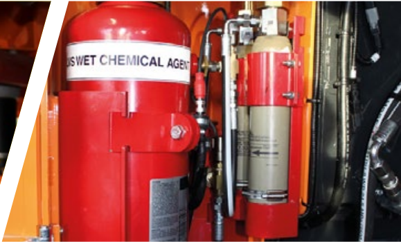
Sistema automático de extinción de incendios
