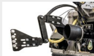
Dispositivo de autoalineamiento entre eje de toma de fuerza PTO/transmisión tipo W permite que el implemento trabaje en diversos ángulos sin dañar el PTO
