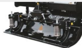
**Cuchilla niveladora (kit de carretera)** para el mantenimiento de carreteras no asfaltadas (STCM - STCM/HP)
