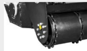
**Rodillo de accionamiento hidráulico con raspador**
