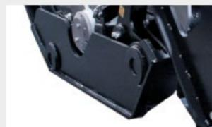
**Patines hidráulicos** ajustables permiten que el rotor penetre en el suelo para trituración de raíces y tocones a profundidad
