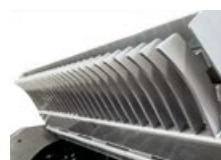
Parrilla en compuerta trasera La parrilla en la compuerta trasera contribuye a definir el tamaño del material procesado
