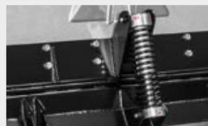
**Barras dosificadoras amortiguadas** para nivelar y compactar el material triturado, creando una base homogénea
