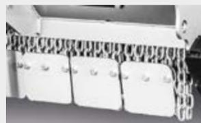
**Láminas con cadenas de protección atornilladas**
