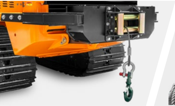
Hintere Seilwinde mit 13 t Zugkraft
