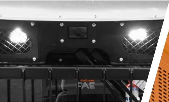
Sichtbarkeitspaket (LED-Scheinwerfer + Heckkamera)
