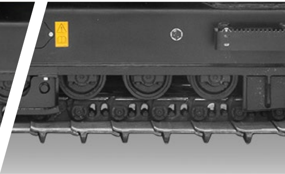
Steinschlagschutz für Fahrwerk-Walzen und -Antriebsrad
