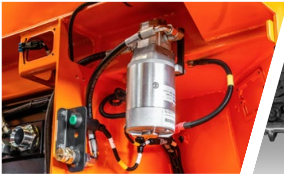
Paket für einfache Wartung (Öl-Füllpumpe)
