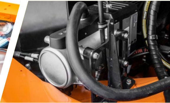
System zum Vorwärmen von Motor und Hydrauliköl
