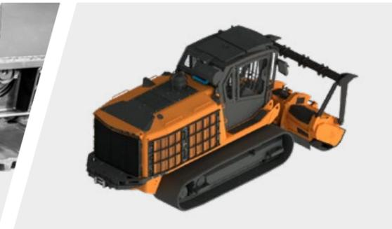
Kit Forstschutzeinrichtungen (Schutzgitter Seitenscheiben Kabine + Motorraum-Türenschutz)
