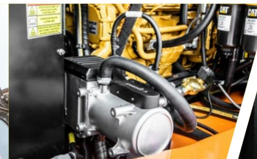
System zum Vorwärmen von Motor und Hydrauliköl
