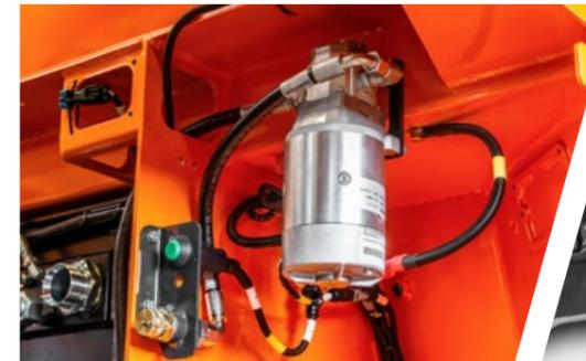
Paket für einfache Wartung (Öl-Füllpumpe)
