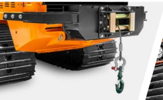
Hintere Seilwinde mit 6 t Zugkraft
