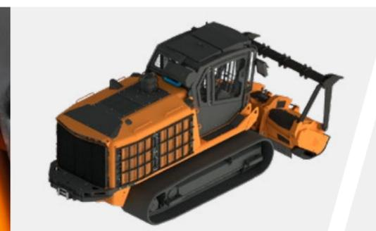
Kit Forstschutzeinrichtungen (Schutzgitter Seitenscheiben Kabine + Motorraum-Türenschutz)
