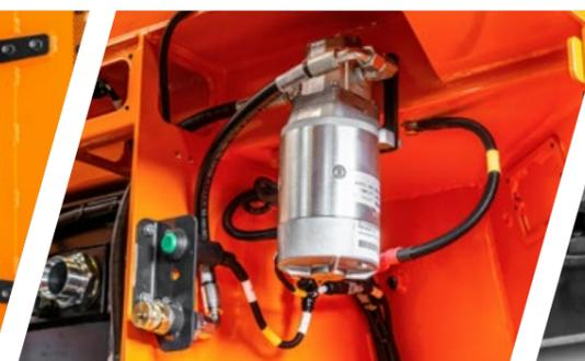
Paket für einfache Wartung (Öl-Füllpumpe)
