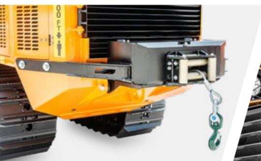
Hinterere Seilwinde mit 6 t Zugkraft
