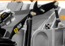
Tiefenanzeiger für genaue Arbeitssteuerung
