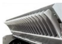
**Rückwärtiges Gitter an der Klappe** ermöglicht das Zurückhalten und erneute Brechen des grobkörnigeren Teils, um eine optimale Beschaffenheit des Materials zu erreichen
