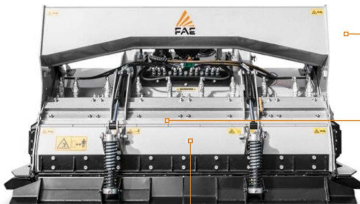
**Seitliche Schutzverkleidungen** die seitlichen Schutzverkleidungen an der Innenseite können leicht ausgetauscht werden, ohne den Fräsrotor abbauen zu müssen: sie gewährleisten hohe Verschleißfestigkeit und reduzieren die für den Austausch notwendige Zeit
