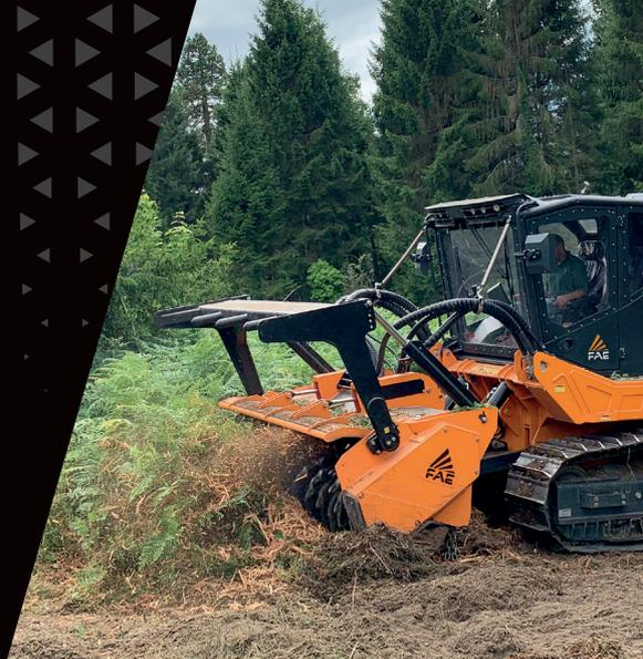
Hydraulischer Antrieb der Drückevorrichtung (Option)
