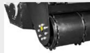
**Hydraulische regelbare Laufwalze**
