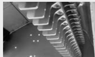
Unabhängiges Gitter gestattet die Regelung der Körnunggröße des ausgestoßenen Materials; ein vergrößerter Abstand zwischen dem Gitter und der hinteren Klappe ermöglicht einen besseren Materialfluss
