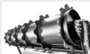
Hydraulische regelbare Laufwalze oder Breite Walze gestattet die Regelung der Körnunggröße des ausgestoßenen Materials
